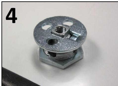
**4** – Retirer le mécanisme complet de fermeture « 3 points » ainsi que la rondelle au dos de la serrure.
